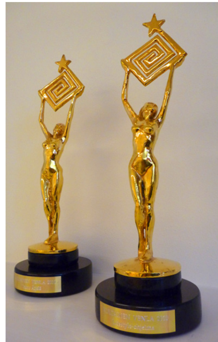
Kultainen Venla on pronssiin valettu patsas, joka on kullattu 24 karaatin kullalla. Patsaan jalusta on graniittia. Entisöinti Pulla Oy yhteistyökumppaneineen on valmistanut Kultainen Venla -patsaat tänäkin vuonna.
